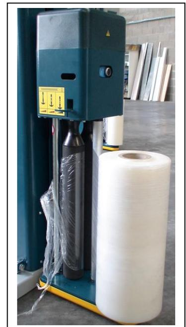
Le chariot « PPS » assure une économie de film importante jusqu'à plus de 50 % par rapport aux chariots classiques à frein et de plus permet de porter le film en phase plastique pour une meilleure stabilisation de la charge.
