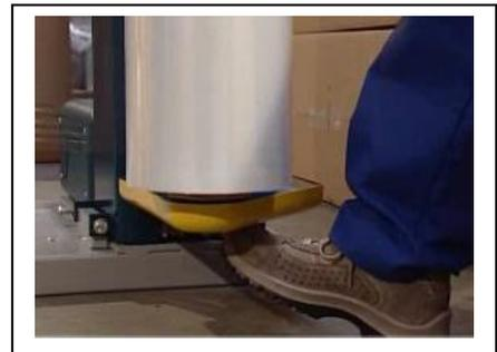
Châssis, plateau et mat à structure renforcée indéformable
